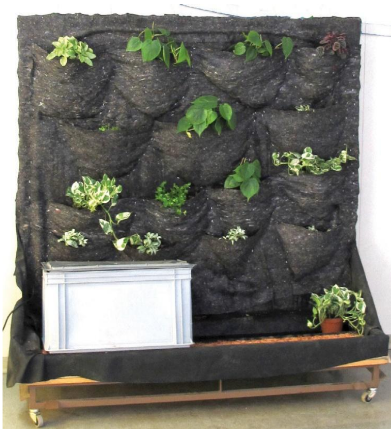
Figura 1: Vegetación vertical en interiores con bolsillos de vellón
