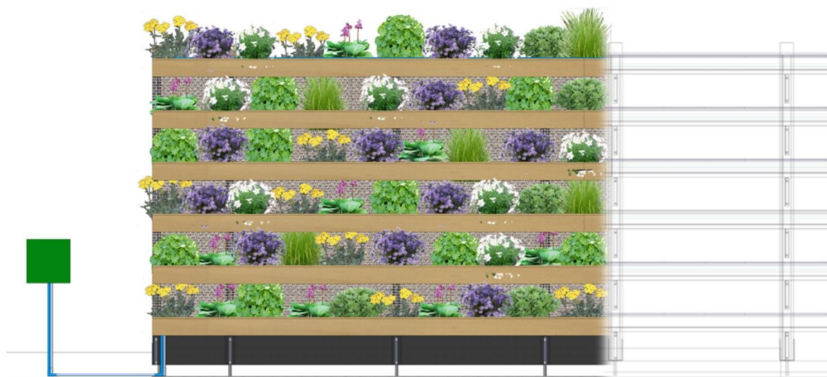
Fíor 2: Radharc tosaigh amhairc ar bhalla glas EVAP0+ - glasáilte (ar chlé) agus i mbun tógála (ar dheis)
