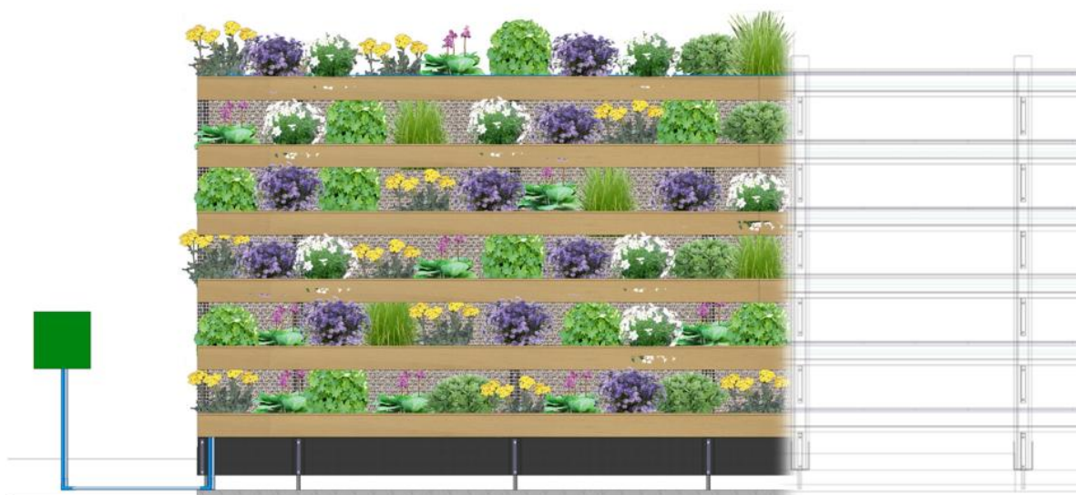
Abbildung 3: Visualisierung Frontalansicht EVAPO+ Grünwand – begrünt (links) und Konstruktion (rechts)
